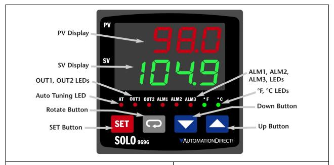
**PV Display:** process value or parameter type **SV Display:** setpoint or parameter value
